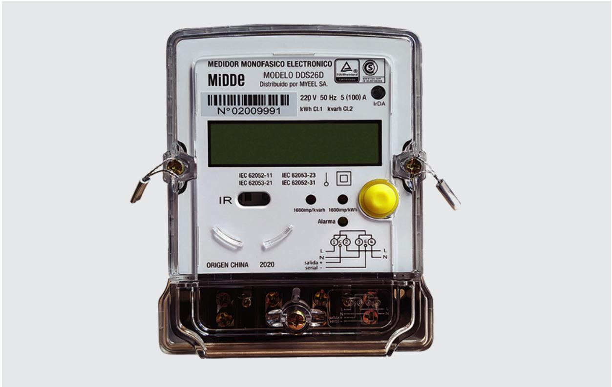
El medidor de energía electrónico multifunción monofásico DDS26D se utiliza para medir energía Activa en Corriente Alterna monofásica a 50 Hz y 220 /240 V. Su performance cumple con todos los requerimientos técnicos para los medidores monofásicos de vatios-hora clase 1 según la norma IEC62053-21.
