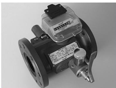
Existen dos versiones de turbinas; libres de mantenimiento, estos equipos cuentan con rodamientos auto-lubricados, o equipos con lubricación externa, mediante bomba inyectora de aceite (detalle en fotografía) . La lubricación se debe realizar cada 2(dos) o 3(tres) meses en condiciones de gas normal, o mas seguido en caso de gases mas contaminados.
